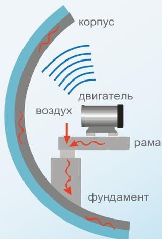
Принцип действия звукоизолирующего покрытия
