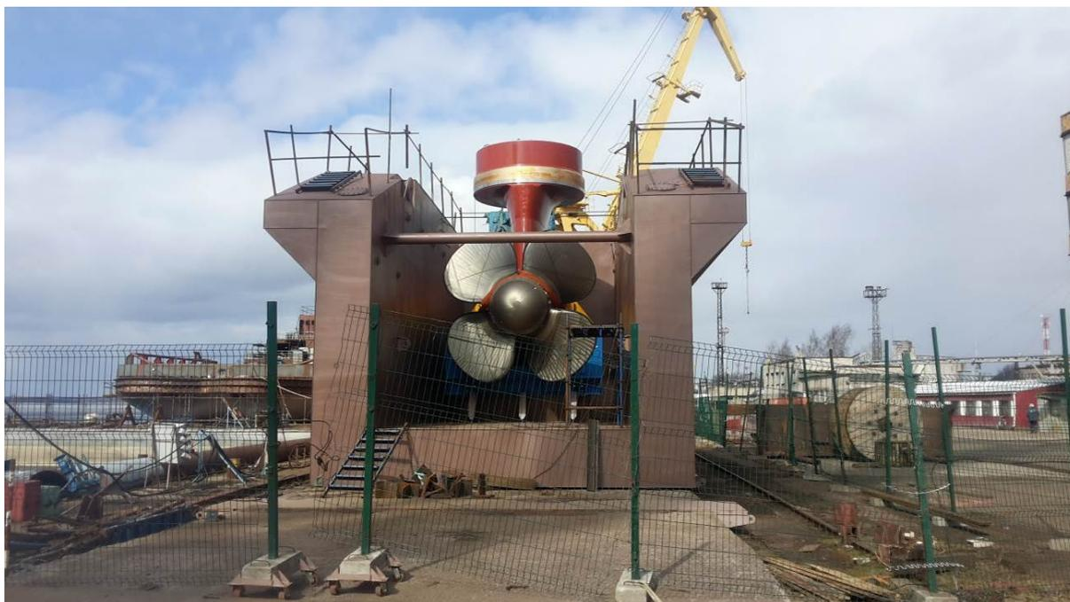
Рисунок 1. Винто-рулевая колонка фирмы Azipod в понтоне проекта P05A перед установкой на судне
