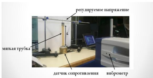
Рис.1 – установка для экспериментального исследования мягкой цилиндрической трубки.
