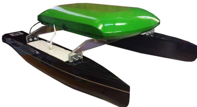
Рисунок 1 – Разработанный автономный необитаемый надводный аппарат осмотрового класса
