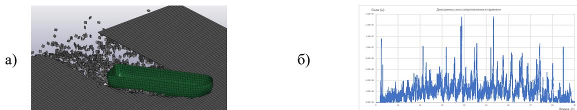
Рисунок 1 – Прокладка судном ледового канала с курсовым углом  $30^\circ$  (а) и история изменения глобальной ледовой нагрузки в процессе взаимодействия. (б)
