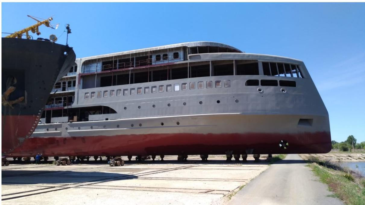
Рисунок 2. Свес носовой части пассажирского судна проекта PV300VD
