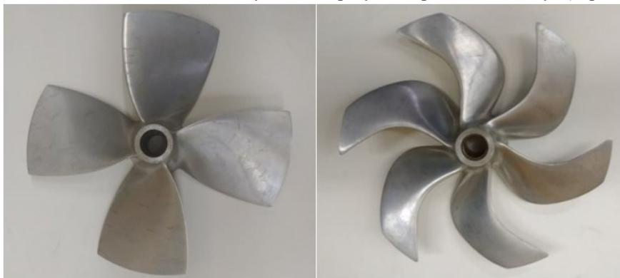
Рисунок 2 – Модели 4-х лопастного гребного винта (слева) и 6-ти лопастного гребного винта (справа)
