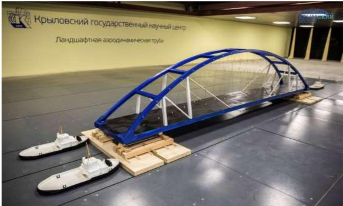
*Рисунок 6.2 – Модель автодорожной арки, понтонов и буксиров в рабочей части Ландшафтной аэродинамической трубы*
