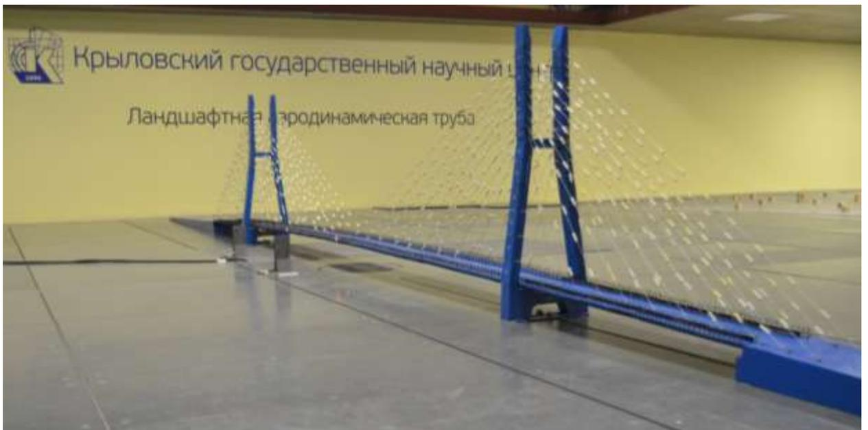
*Рисунок 1.6 – Уругоподобная модель моста в рабочей части ЛАТ*
