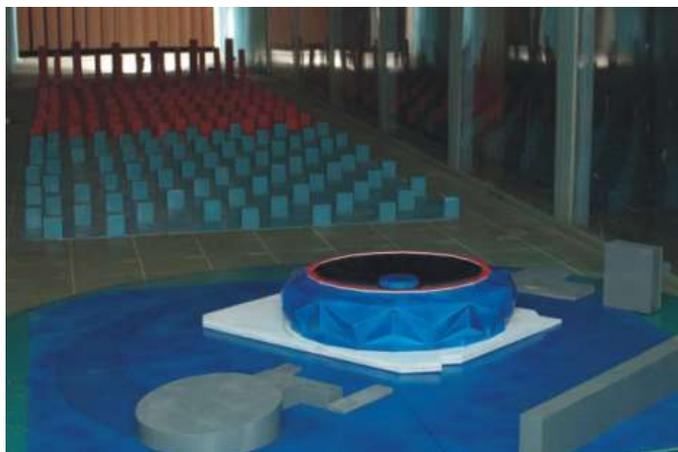
*Рисунок 3.21 – Элементы дискретной шероховатости в рабочей части аэродинамической трубы фирмы Уникон (фото с сайта компании Уникон)*
