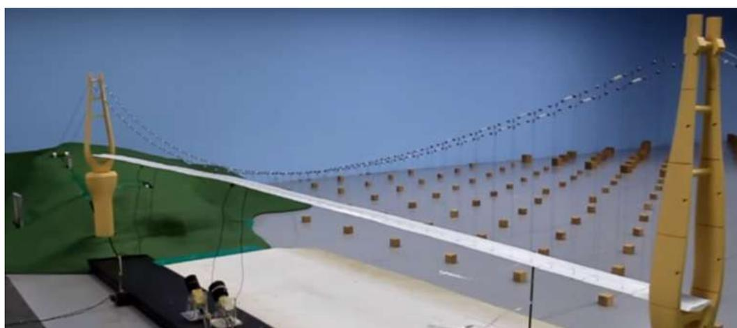
*Рисунок 1.21 - Фотографии моделей в рабочей части аэродинамической трубы TE Solution: а) стадион Минск, б) ландшафт местности Everland, в) аэропругая модель большепролетного моста. Фото с сайта компании TE Solution*
