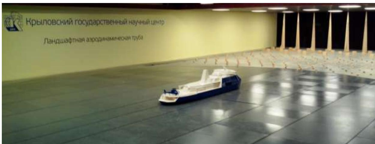
Рисунок 4.23 – Модель надводной части ледокола-лидера в рабочей части ЛАТ
