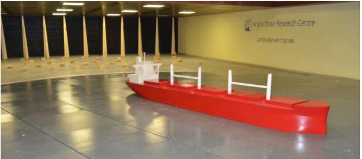
*Рисунок 1.5 – Модель балкера в рабочей части ЛАТ*
