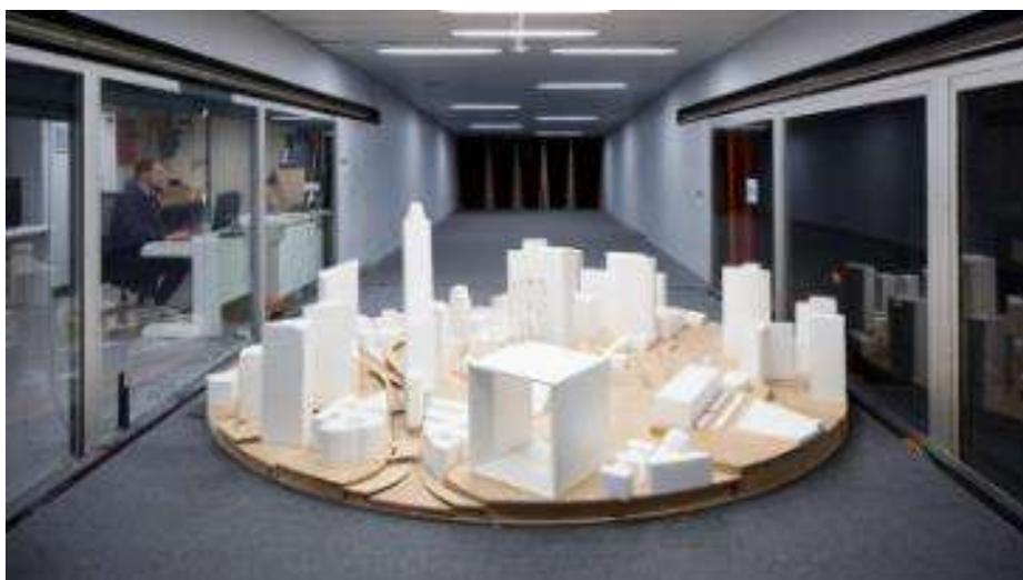
*Рисунок 1.9 – Фотография модели жилой застройки в рабочей части аэродинамической трубы CSTB. Фото с сайта центра CSTB*
